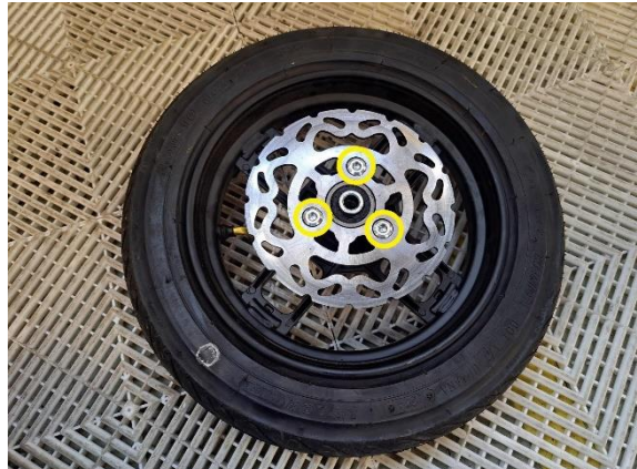
Irrota jarrulevyn kiinnityspultit (kuusiokoloavain 6 mm).
