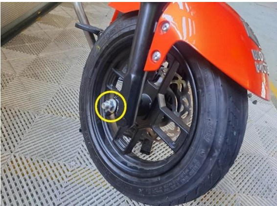
Irrota etuakselin lukitusmutteri (kiintoavain 14 mm, 17 mm).
